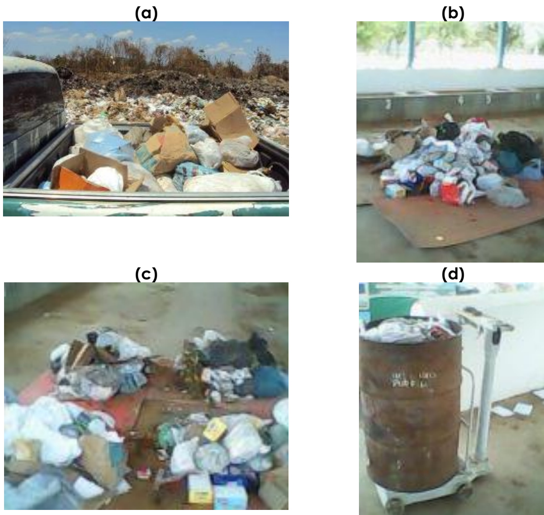
Figura 30 - Processo de determinação da composição gravimétrica. (a) Coleta das amostras, (b) Preparação das amostras e (c) Disposição dos resíduos o quartearmento, (d) pesagem.
